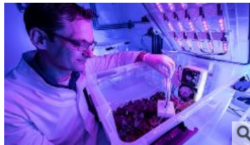
Prof. Dr. Stefan Streif kontrolliert im Speziallabor für vernetzte Agrarsysteme an der TU Chemnitz die Bewässerung, das Beleuchtungsspektrum und die Belüftung einer hydroponischen Pflanzenkultur.
